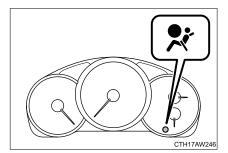
Un système de diagnostic continuellement contrôle la fonctionnalité du système d'airbag SRS (y-compris les prétensionneurs des ceintures de sécurité avants) lors de la conduite du véhicule. Le témoin lumineux du système d'airbags l'opération SRS montrera normale en s'allumant pendant environ 6 secondes guand le contacteur de démarrage est mis en position "ON".
