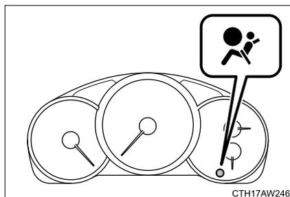
Un système de diagnostic contrôle continuellement la fonctionnalité du système d'airbag SRS (y-compris les prétensionneurs des ceintures de sécurité avants) lors de la conduite du véhicule. Le témoin lumineux du système d'airbags SRS montrera l'opération normale en s'allumant pendant environ 6 secondes quand le contacteur de démarrage est mis en position "ON".
